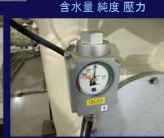
.) 9 氣體取樣測試 含水量 純度 壓力
