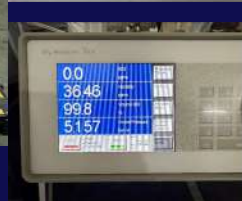
.) 9 氣體取樣測試 含水量 純度 壓力
